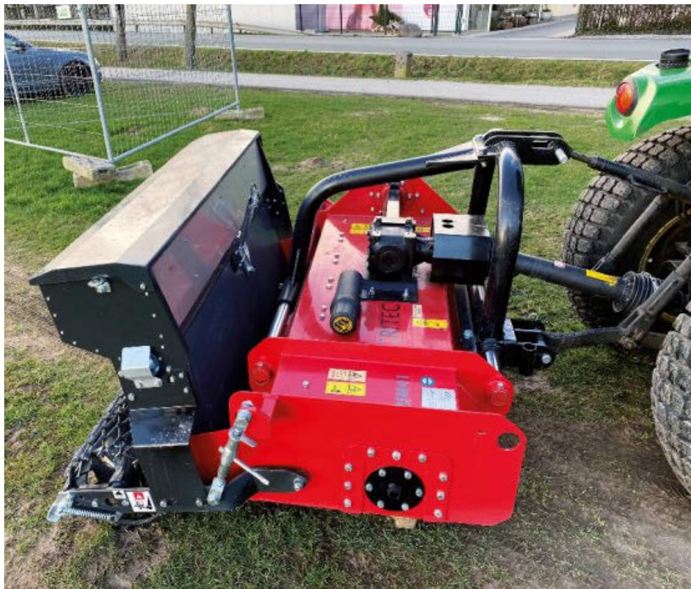
Bild links: Eine Umkehrfräse sollte ordentlich Gewicht haben, sonst springt sie bei Unebenheiten.
